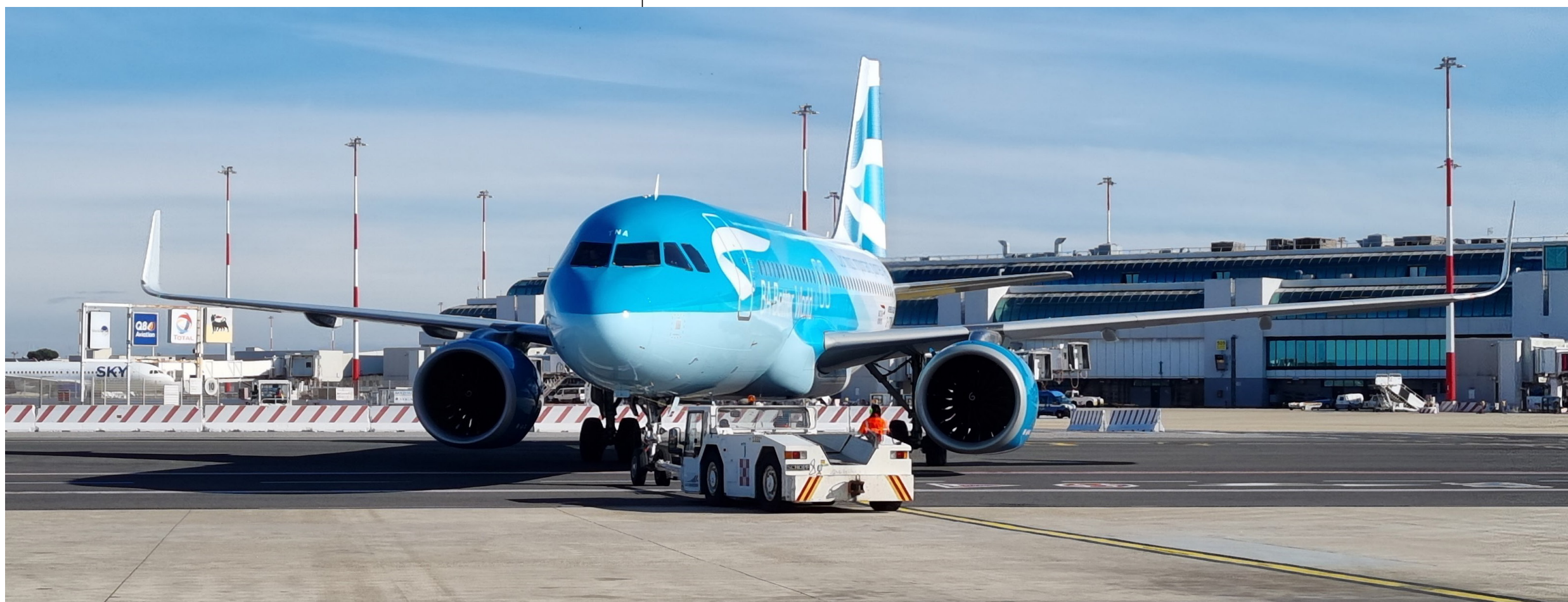
Operazione di push-back che attraversa la viabilità
