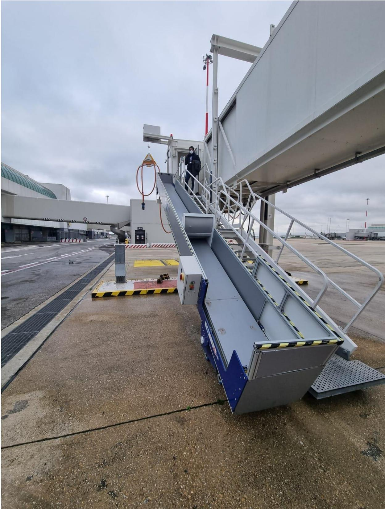
*Immagine 1. Scivolo motorizzato installato presso un pontile di imbarco, quota pista*
