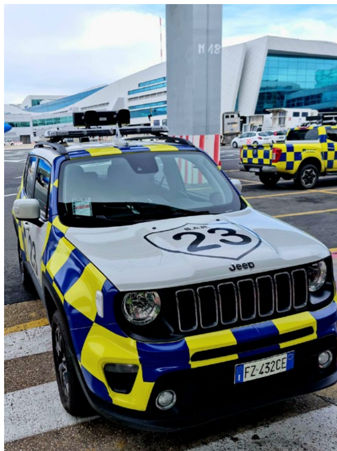
Uno degli automezzi con le ruote 4x4 e un sistema acustico di allontanamento volatili di ADR.
