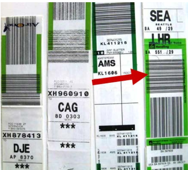
Codice a barre tra le bande verdi per uso di carta non compatibile col settaggio della tag pinter
